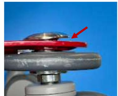
本体を少し浮かして、車輪を動かすとカタカタと動きます
