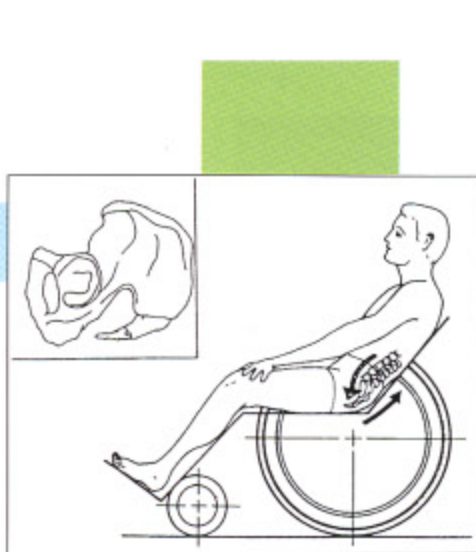
(第3図) 車椅子で骨盤が落ち込んだ姿勢。仙骨部分での圧が増大し、剪断力が生じている。
