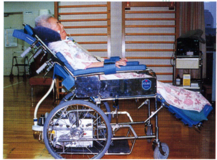
写真2 人工呼吸器を搭載できるように座面を高くして板を渡しているリクライニング車椅子
