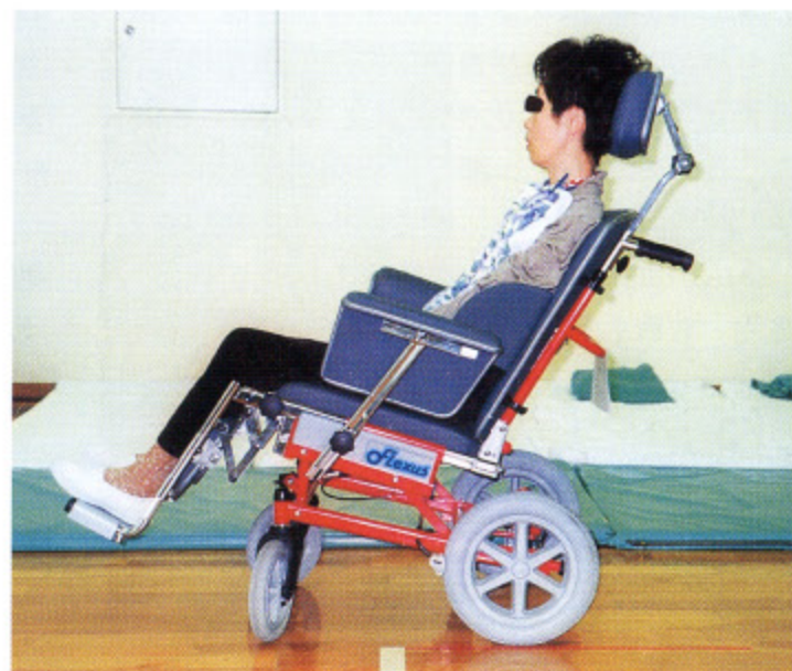
写真5 リクライニング角度110度、振り子角度20度で心地よい座位をとっているところ
