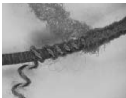
図 2重巻きゴム糸(7倍の拡大写真)
