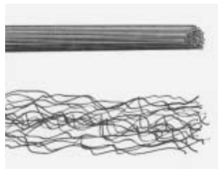
図 2つの多繊維撚り糸のスケッチ。織られていないもの(上図)と織られた糸(下図)との比較
