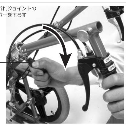
左右の背もたれの背折れジョイントを下げる、背もたれ部を後ろへ折りたたみます。
