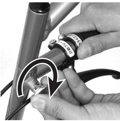
延長バーの固定つまみを引いて時計回りの方向へ回し、溝から外します。
