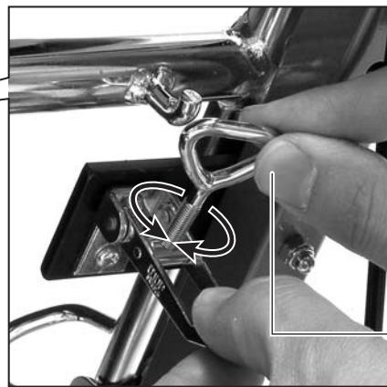
T字金具を閉じた状況です。T字金具の固定力が弱かったり、固定できない場合は右上写真のようにT字金具のつまみを回して固定力を調整して下さい。
