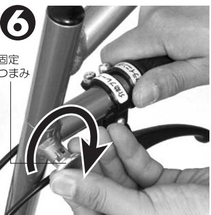
延長バーの固定つまみを引いて時計回りの方向へ回し、溝にはめ込みます。
